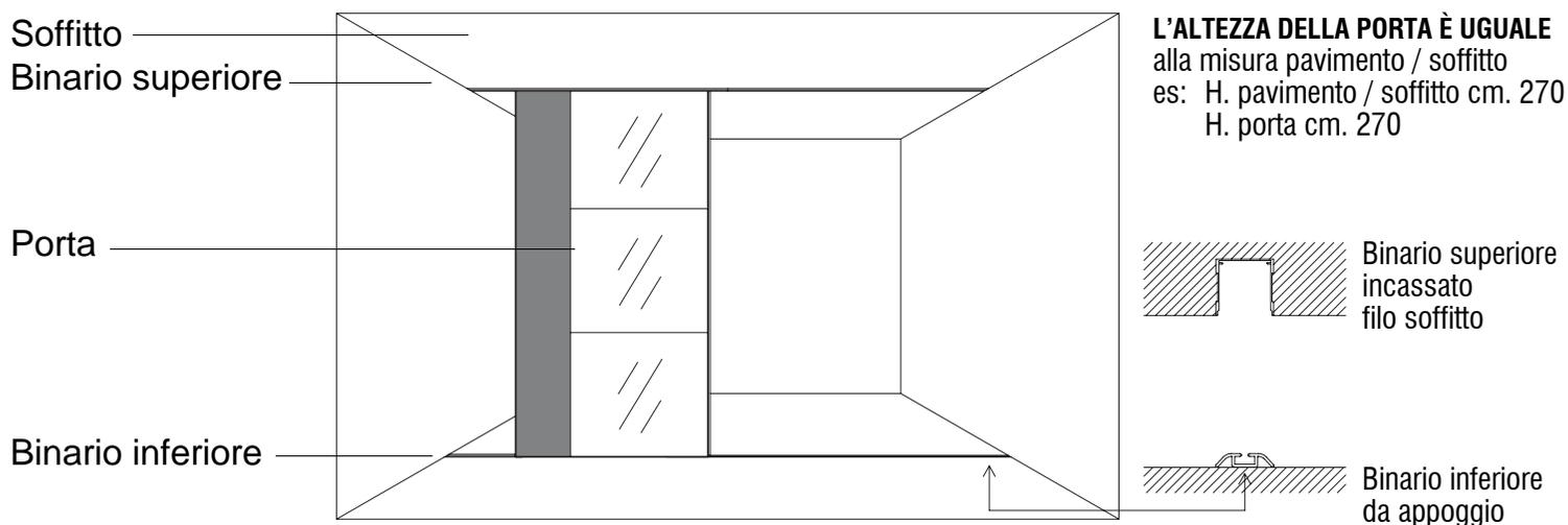
Esempio di porta con binario superiore incassato filo soffitto e binario inferiore incassato filo pavimento.
